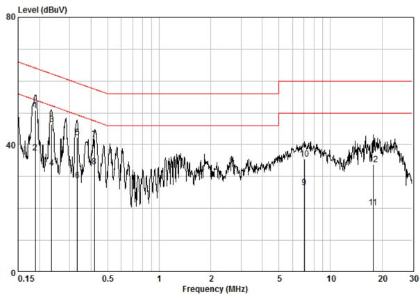
Site : Shielding Room Condition : CE NEUTRAL Job No. : 10750RG Test Mode : b
