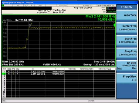
Number of Hopping Frequencies 2 <u>Hopping mode : Enable &  $\pi/4$ -DQPSK</u>
